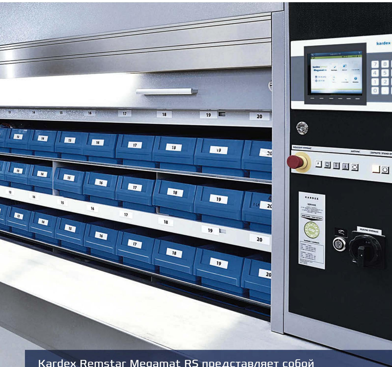
Kardex Remstar Megamat RS представляет собой автоматизированный вертикальный карусельный склад типа патерностер, работающий в соответствии с принципом «товар к человеку», что делает его идеальным для часто используемых товаров.
