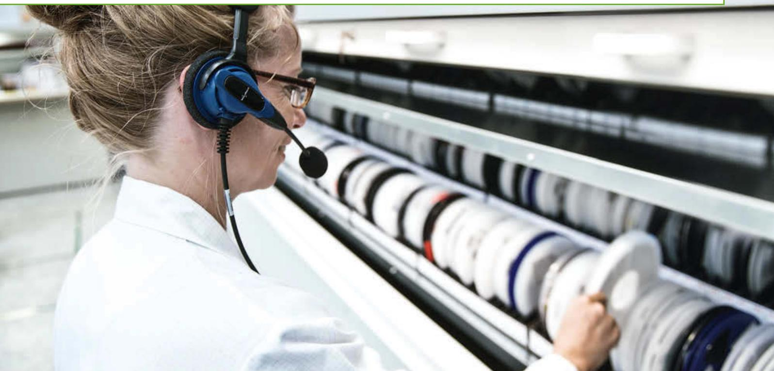
**Kardex Remstar Megamat RS представляет собой автоматизированный склад карусельного типа. Его конструкция напоминает патерностер (лифт непрерывного действия), работающий по принципу «товар к человеку», что оптимально подходит для часто востребованных складированных материалов.**
