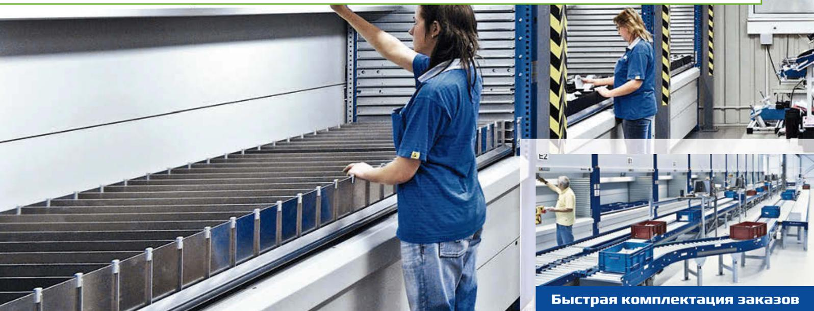
**Kardex Remstar Shuttle XP является автоматизированной многоярусной складской системой с модульной конструкцией, которая работает в соответствии с принципом «товар к человеку», что делает ее идеальной для оптимальной плотности хранения и гибких, эффективных стратегий хранения.**
